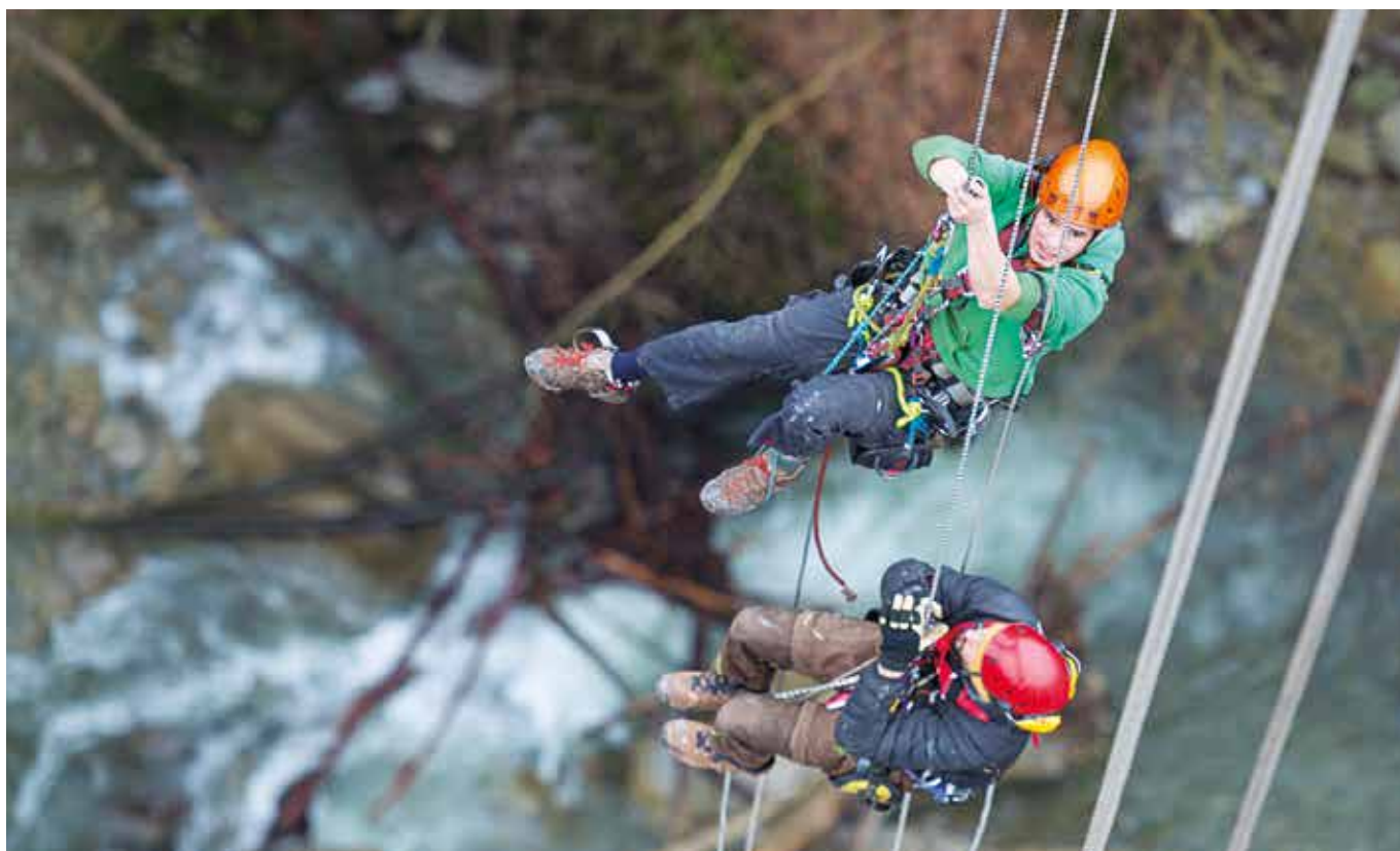
Risalita dopo alcune prove di calata con i prototipi del discensore Giant. Remontée après quelques essais de descente avec les prototypes du descendeur Giant. Aufstieg nach einigen Abseilproben mit den Prototypen des Abseilgeräts Giant. Pont de Fenil, Vaud, Switzerland (courtesy of Corde-Access SA, ph. Mauro Galimberti).
