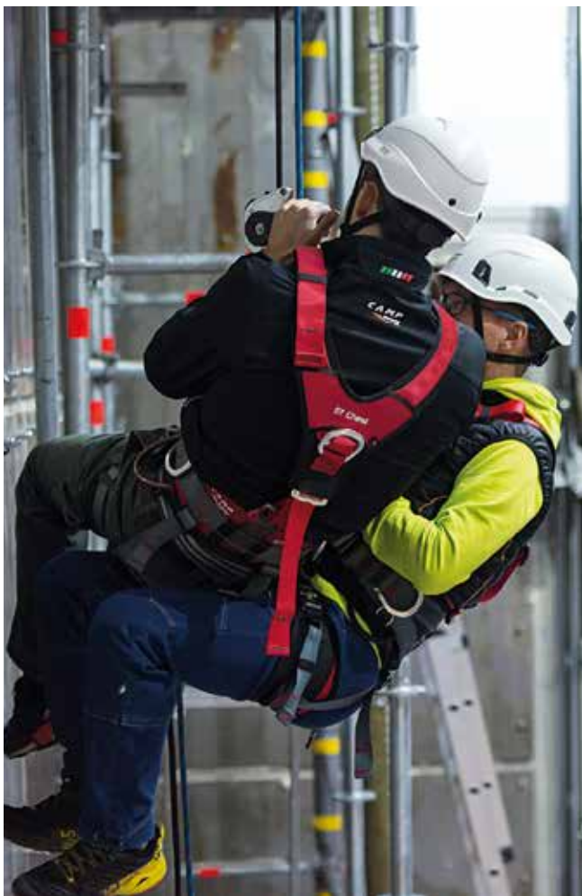
Prove di evacuazione di emergenza con due persone con un prototipo del discensore Giant. Test d'évacuation d'urgence avec deux personnes avec un prototype du descendeur Giant. Notfall-evakuierungsprobe zweier Personen mit einem Prototyp des Abseilgeräts Giant. Corde-Access SA training centre, Puidoux, Vaud, Switzerland (ph. Mauro Galimberti).
