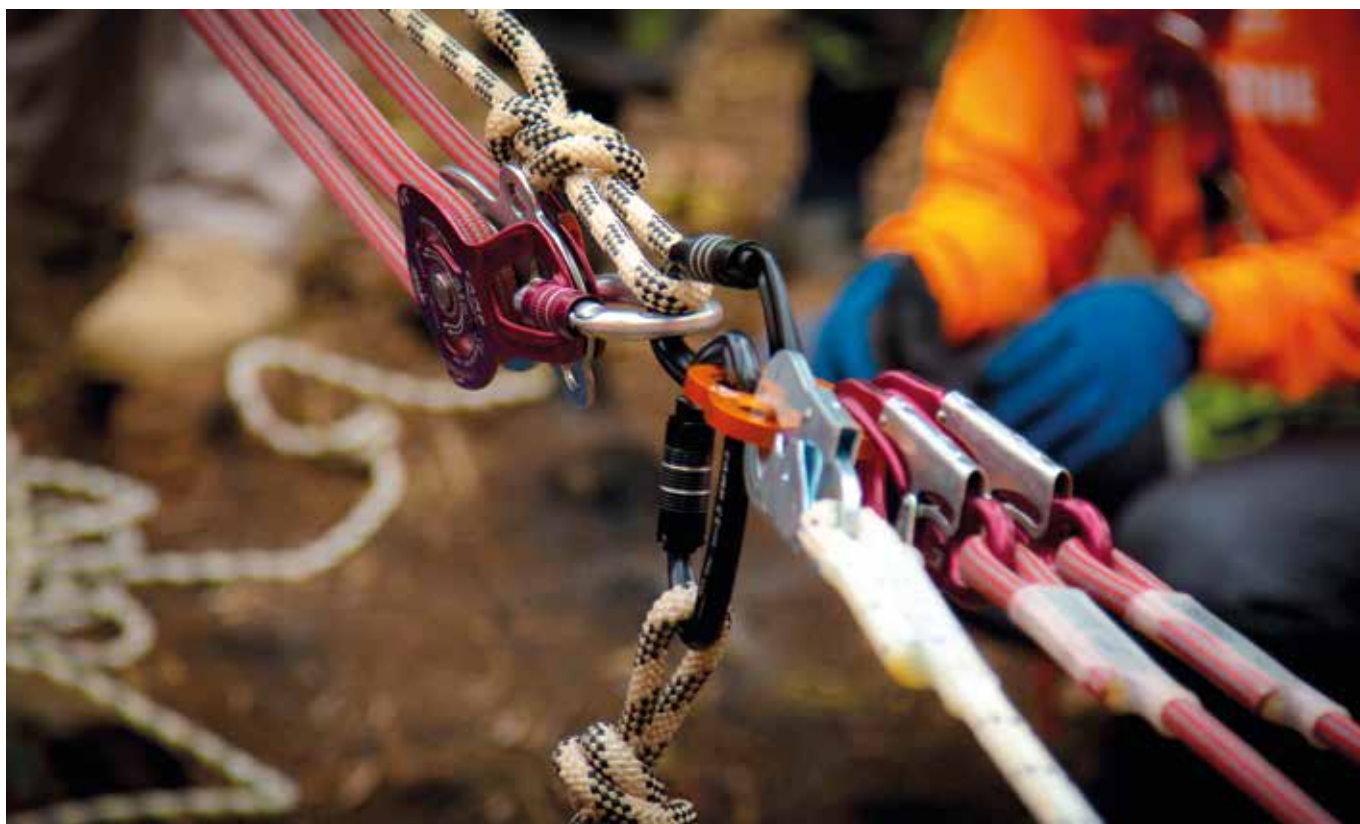
Dimostrazione di un paranco durante il corso di formazione per il soccorso tenuto dai tecnici CAMP nella giungla thailandese. Démonstration d'un mouflage lors du cours de sauvetage organisé par des techniciens CAMP dans la jungle thaïlandaise. Techniker von CAMP veranschaulichen ein Flaschenzugsystem während einer Fortbildung der Rettungseinheit im thailändischen Dschungel. Chiang Mai Region, Thailand (courtesy of High Solution Network Co. Ltd.)
