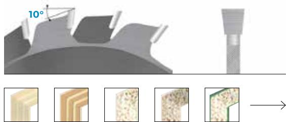
Lame indicate su macchine sezionatrici e adatte alla sezionatura del rivestimento di pannelli bilaminati e MDF. Dentatura piatta.
