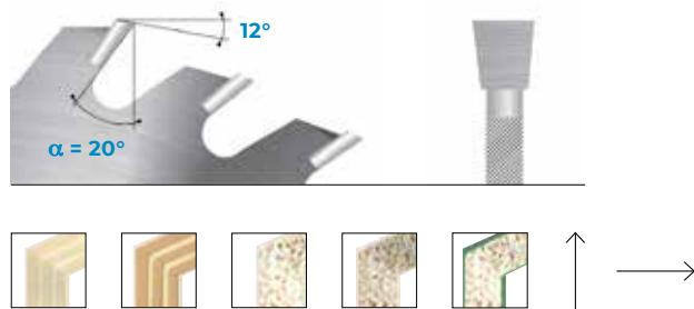
— Lame usate per eseguire canali a misura fissa. Taglio lungo e traverso vena di legni duri, teneri, esotici e pannelli con rivestimento plastico. Dentatura piatta.
