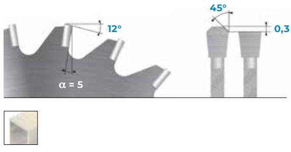
Lame per il taglio di profili in alluminio e sue leghe, zinco, rame, ottone e bronzo. Dente trapezoidale Positivo consigliato su macchine automatiche.
