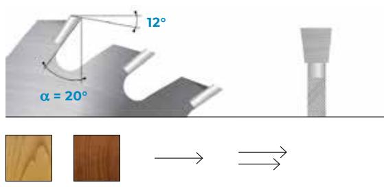
Lame circolari a più rasanti, perfette per tagli multipli di legni umidi e difficili da gestire. I rasanti inseriti nel corpo della lama impediscono la chiusura del taglio. Dentatura piatta.
