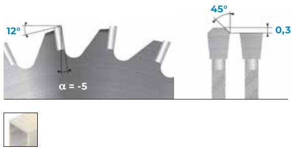
Lame per il taglio di profili in alluminio e sue leghe, zinco, rame, ottone e bronzo. Dente trapezoidale Negativo consigliato su macchine automatiche.
