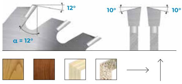
Taglio lungo e traverso vena di legni duri, teneri e compensati. Dentatura alternata.
