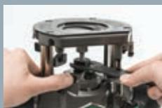
Facile sostituzione della fresa
