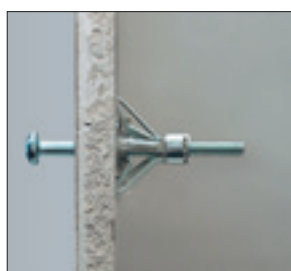
3. Svitare leggermente la vite, per una porzione sufficiente all'inserimento della testa della vite nello speciale utensile (serie HQ); quindi azionare l'utensile a pistola, fino ad ottenere l'apertura a "stella" dell' ancorante.
