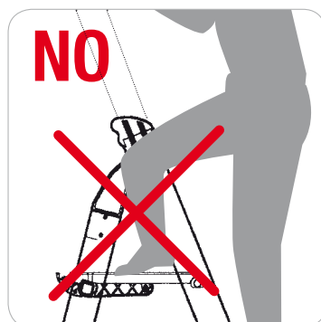
Pedana non calpestabile. La scala non ha il paracorpo
