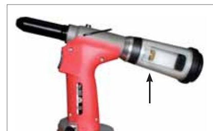
Pomolo regolazione aspirazione. Knob for suction adjusting.
