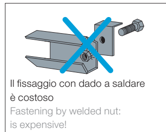
L'inserto è la soluzione migliore The best solution: threaded rivet nut
