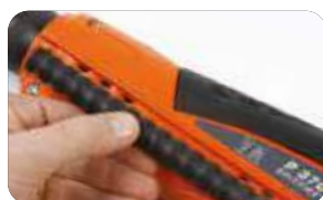
Controllare l'usura della molla sulla scala graduata. Sostituire almeno ogni 2.000 colpi
