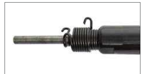
Ribattitore con punzone montato. Riveting gun with punch.
