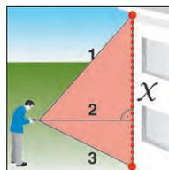
**Teorema di pitagora con sensore di inclinazione:** la presenza del sensore di inclinazione velocizza le misurazioni indirette riducendo, ad esempio nel teorema di Pitagora, le azioni in sequenza necessarie per completare l'operazione. Inoltre permette la misurazione di altezze anche in posizioni difficili o impossibili da raggiungere, come quella di una finestra o di un balcone lavorando da terra.
