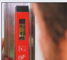
SISTEMA "EASY VIEW": LA FINESTRA DI LETTURA SUL CORPO SUPERIORE PERMETTE DI LEGGERE LA BOLLA ANCHE CON LA LIVELLA IN VERTICALE
