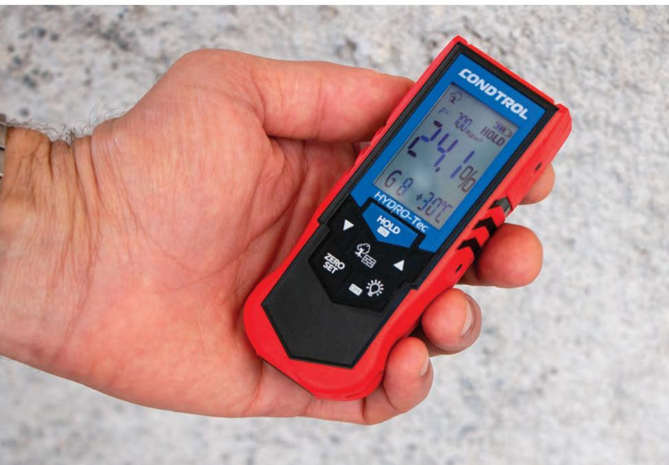
Rilevatore di umidità del legno e dei materiali da costruzione.
