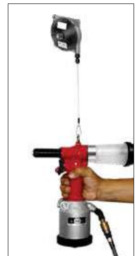
Applicazione attacco superiore Used with upper hook
