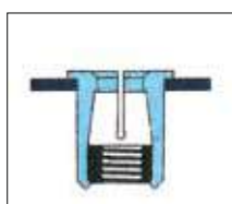
Spingere l'inserto dentro al foro. Press the fastener into the hole.
