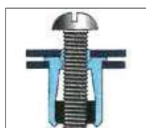
Avvitare la vite fino a che non si incontra resistenza o fino ai limiti di torsione indicati. Drive the screw until solid resistance is felt, or up to recommended torque limits.
